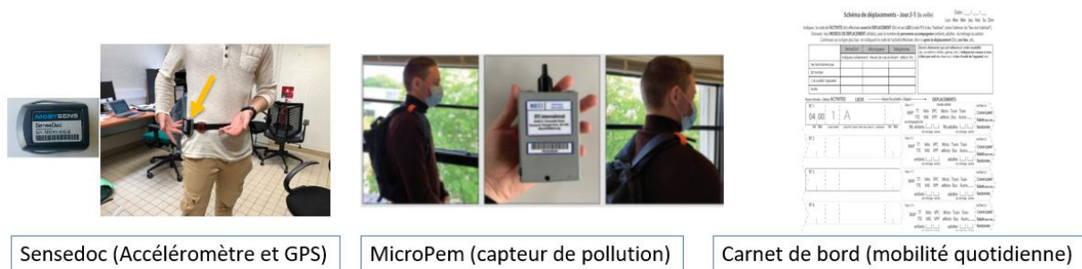
Figure 31. Outils de collecte des données. La figure à gauche montre le capteur Sensedoc qui doit être porté dans une ceinture portée autour de la taille. La figure au milieu montre le capteur MicroPem qui doit être porté dans une sacoche ou dans un sac et le tuyau au plus proche des voies respiratoires. La figure à droite montre une page du carnet de mobilité.
